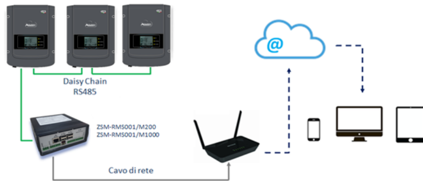
Figura 74 – Schema di funzionamento del datalogger ZSM-RMS001/M200 / ZSM-RMS001/M1000
