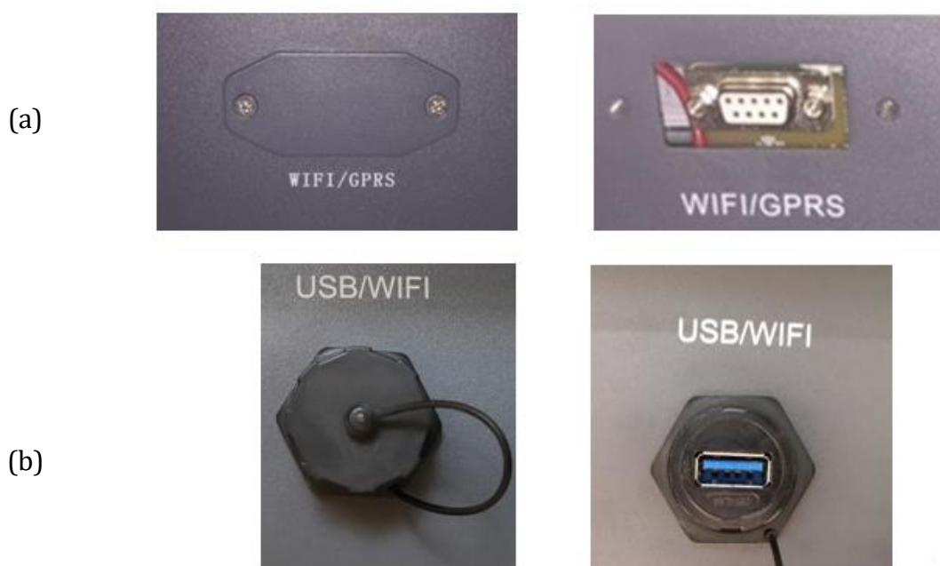
Figura 67 - Alloggiamento della scheda 4G
