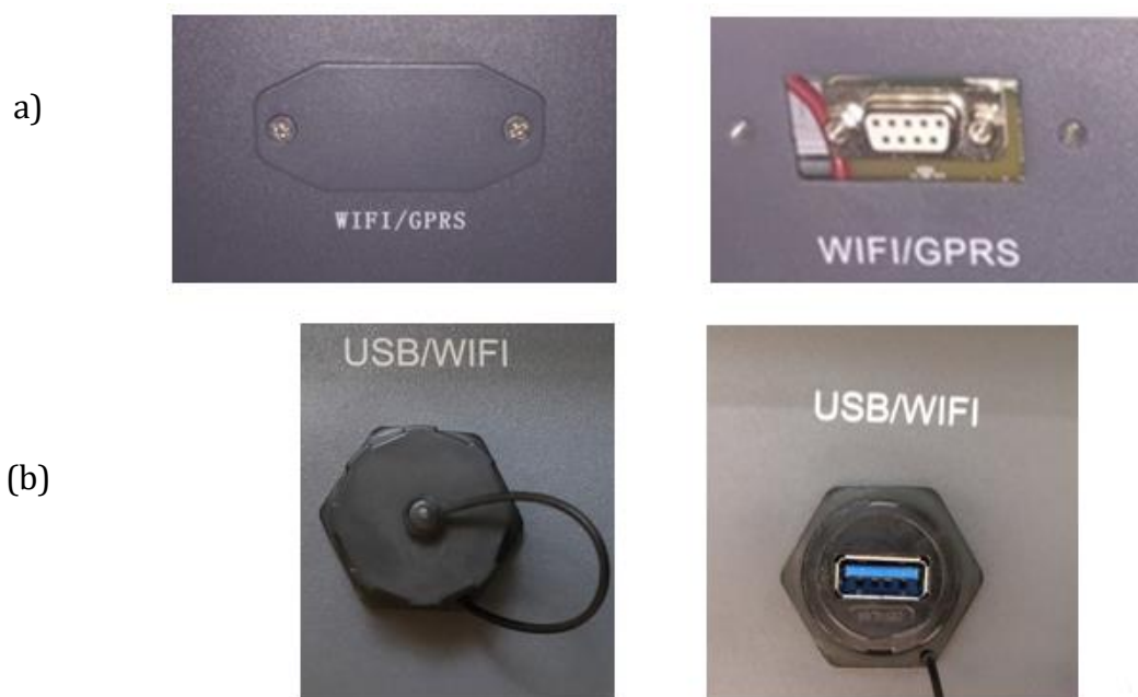
Figura 34 - Alloggiamento della scheda wifi esterna
