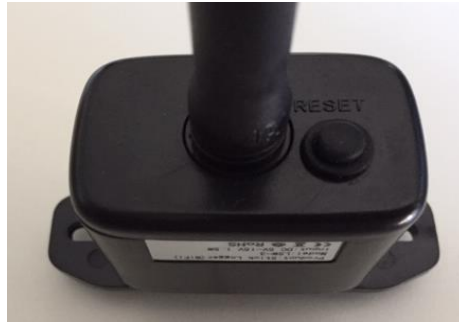
Figura 53 - Tasto di reset sulla scheda wifi
