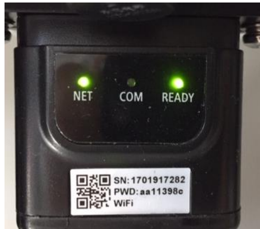
Figura 65 - Stato di comunicazione irregolare tra inverter e scheda
